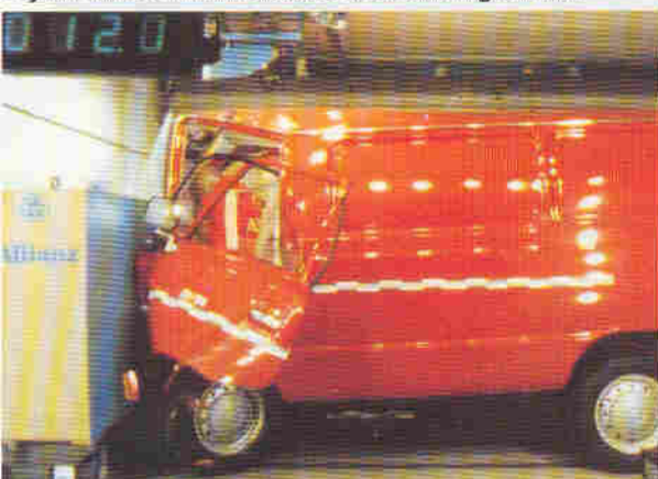
Toyota Lite-Ace: Tür aufgegangen, 65 cm verformt
